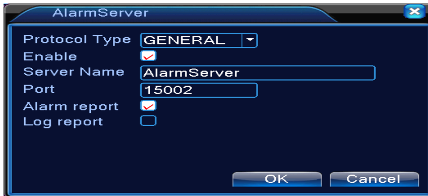
Imagen: 4.30 Configuración servidor alarma.
