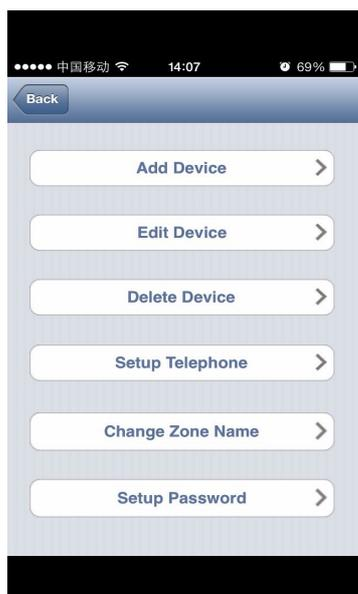
Dispone de 6 opciones: Add Device (Añadir dispositivo), Edit Device (Editar dispositivo), Delete Device (Borrar dispositivo), Setup Telephone (Configurar teléfono), Change Zone Name (Cambiar nombres de zonas), Setup Password (Configuración de contraseña)
