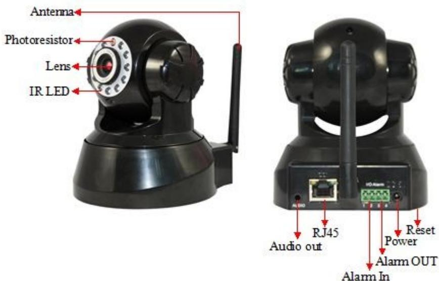
Esta cámara incluye un sensor CMOS de 300K pixels de resolución y una lente de 3.6mm. Incluye funciones motorizadas. Salida de audio y 11 leds de luz infrarroja. Utiliza adaptador alimentación 5V
