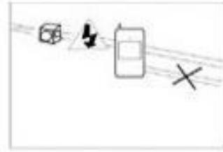
El cableado del detector no puede estar junto con el cable de alta tensión
