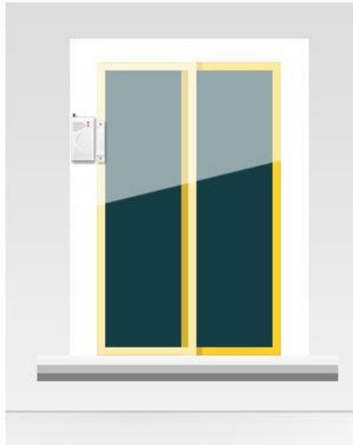
El transmisor inalámbrico está montado en el marco de la ventana. El bloque magnético está montado en la ventana por lo que abrir la ventana generará un desplazamiento y enviará una señal de alarma
