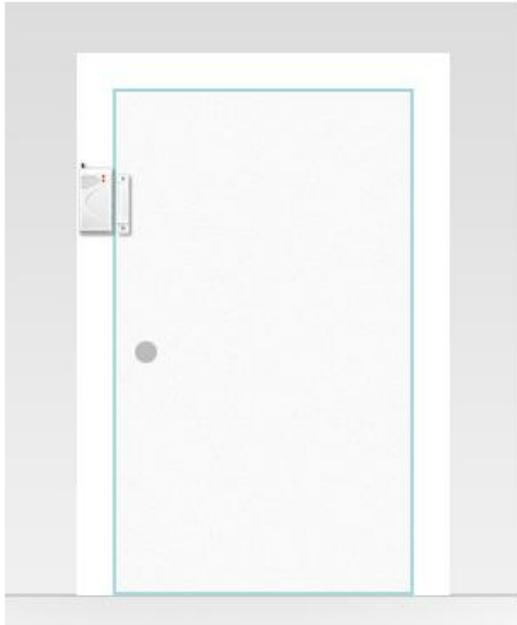
El transmisor inalámbrico está montado en el marco de la puerta. El bloque magnético está montado en la puerta, por lo que abrir la puerta generará un desplazamiento y enviará una señal de alarma.
