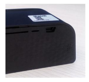
Con un pequeño punzón o destornillador plano puedes hacer palanca en la parte trasera para ver las conexiones de la cámara.
