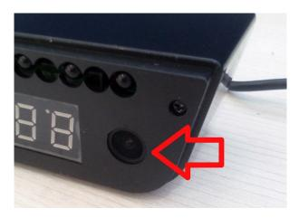
Desde la parte trasera y puedes observar la conexión mini USB para alimentar la cámara. La cámara puede funcionar de manera continua mediante este cable conectado a una alimentación 5Vdc o bien con una batería interna. Aunque debes tener en cuenta al utilizar mediante la batería interna la duración de la cámara será menor.
