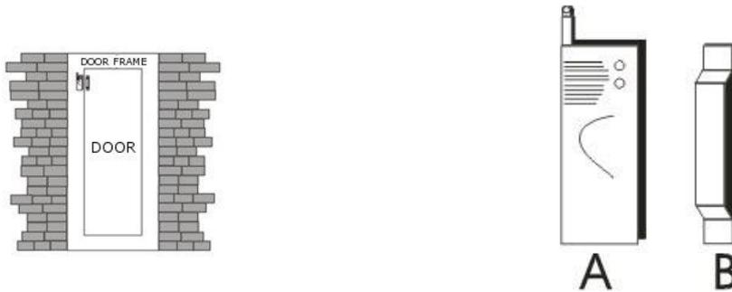
1. La superficie donde necesitas pegar el sensor de puerta debe estar limpia para que pueda unirse mediante el adhesivo de doble cara.
