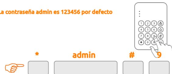
**Nota:** Si no realizas una operación en 30 segundos el teclado saldrá de la configuración. El usuario puede presionar el icono del candado cerrado, abierto, armado en casa o SMS durante la programación. El teclado emitirá 2 pitidos al salir de la configuración
