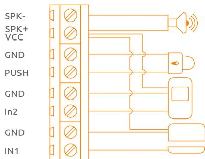
1. Conecta un cable a IN1 o IN2 y otro a GND. Si el sensor no necesita alimentación puedes dejarlo de esta forma. Si necesita alimentación conecta VCC
