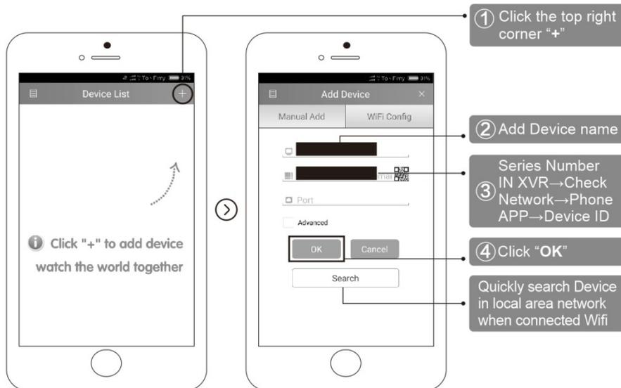
5. Haga clic en el icono “+” situado en la esquina superior derecha para añadir un dispositivo. Seleccione “Input name → Device ID → No password”.
