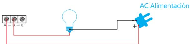
**Atención.** Cuando conectes el jumper entre la posición 1 y 2 pins, cuatro bombillas a la vez se encenderán y apagarán, o se encenderá y apagarán algunas de ellas. En la posición 2 y 3 el jumper solo puede encender una bombilla a la vez, por ejemplo si ya has encendido la bombilla 1 puedes encender la bombilla 2 y la bombilla 1 se apagará.
