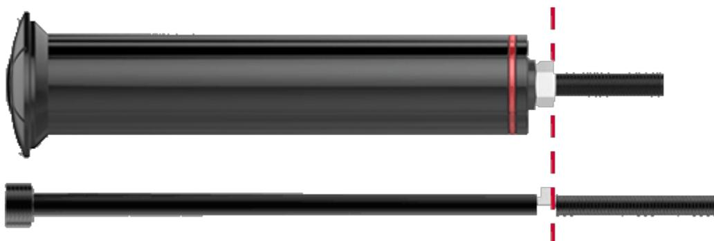
Posiciona la parte superior del tornillo M6 sobre el soporte incluido.
