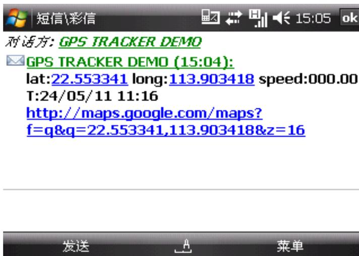
La localización cuando no hay señal GPS se realiza mediante el ultimo registro de latitud y longitud, así como con la posición obtenida mediante el servicio LAC.
