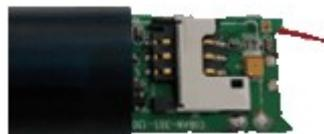
6.1.6 Inserta la tarjeta SIM comprobando los contactos coincidan.
