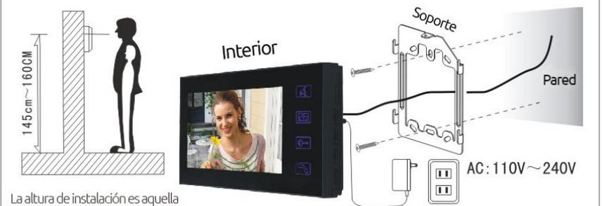
La altura de instalación es aquella en la cual la pantalla queda a la altura de los ojos.
