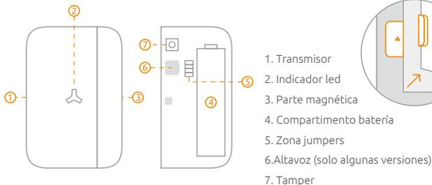
**Alarma por tamper:** Si un intruso manipula el detector, este emitirá un aviso de alarma
