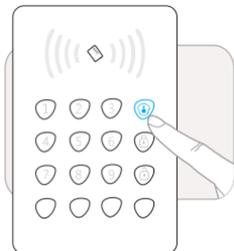
Aunque depende de cada modelo de central alarmas cuando el panel recibe el aviso de armado su sirena interna emitirá un sonido indicando se ha realizado un armado para la zona exterior.
