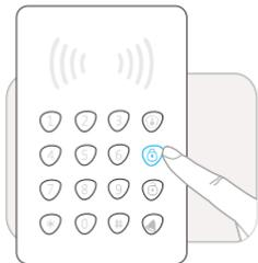
Aunque depende de cada modelo de central alarmas cuando el panel recibe el aviso de armado su sirena interna emitirá un sonido indicando se ha realizado un armado completo.
