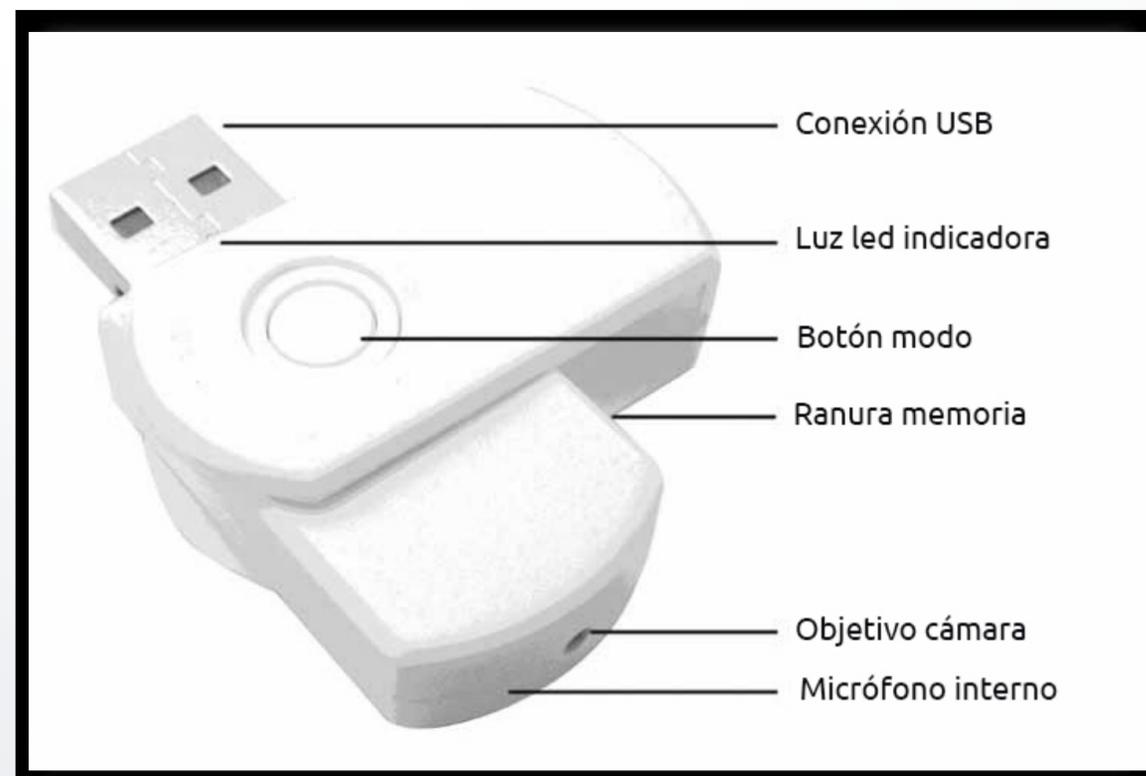
**4. Bajo nivel de batería.** Por la seguridad de las grabaciones de vídeo, cuando el nivel de carga de la batería sea bajo la cámara se apagará automática, parpadeando tres veces el leds. Para poder volver a utilizar la cámara es necesario cargarla conectando a un puerto USB
