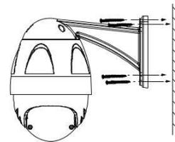
Para fijar la cámara en su ubicación preferida y utilice los tornillos para montarlo.
