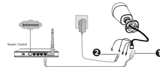
**Nota:** Un adaptador de alimentación no es necesario si el enrutador / conmutador admite la funcionalidad PoE (alimentación a través de Ethernet); de lo contrario, conecte el adaptador de alimentación a la cámara.
