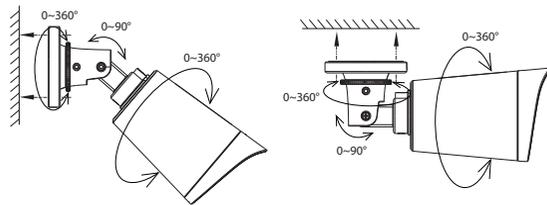
Fije la cámara en su lugar elegido y utilice los tornillos para montarlo. Hemos proporcionado tornillos en el embalaje.
