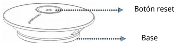
1. Para volver a los valores de fábrica: Conecte el producto a la corriente y pulse el botón reset hasta que parpadee rápidamente (5 veces por segundo) en color rojo.
