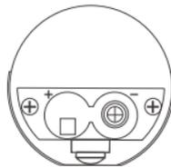
2. Asegure el soporte del detector en la pared. La altura recomendada de instalación son 2 metros sobre el suelo.
