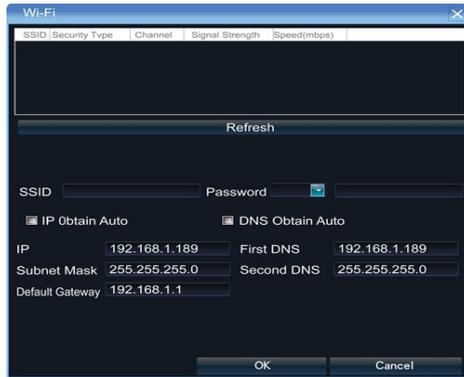
Haga clic en “Refresh”, y puede localizar la red WiFi de su router. Haga doble clic. Introduzca dirección IP, puerta de enlace, DNS1, DNS2 o active obtener IP y DNS automáticamente.
