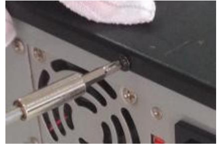
2. Fije el disco duro sobre la carcasa con los tornillos
