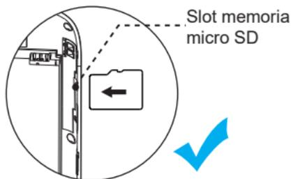
Si intentas introducirla inclinada puedes dañar contacto el interno
