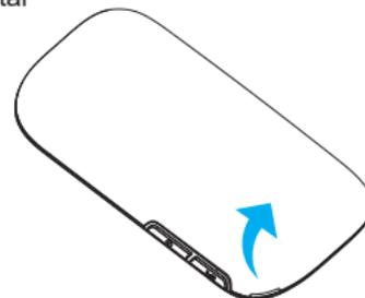
2. Apaga el dispositivo retirando la batería e introduce la tarjeta SIM en su posición marcada con el chip hacia abajo.
