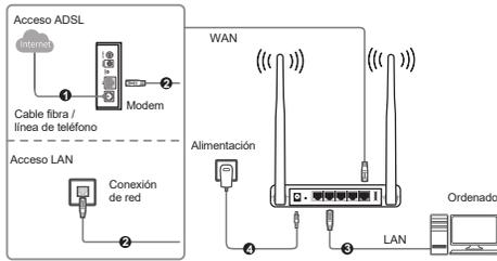
Tras realizar las conexiones comprueba el estado de los leds
