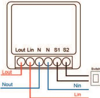
Atención: S1 y S2 solo pueden conectarse al final a un interruptor de pared y no pueden conectarse a una entrada de tensión
