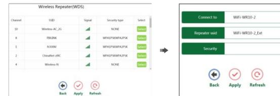
Seleccionar el SSID que corresponde con la red WiFi original a repetir. Insertar la contraseña en el campo Security. El SSID por defecto del repetidor será xxx\_ext. Pulsar en **Apply** para completar la configuración.
