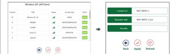
Seleccionar el SSID que corresponde con la red WiFi original a repetir. Insertar la contraseña en el campo Security. El SSID por defecto del repetidor será xxx\_ext. Pulsar en **Apply** para completar la configuración.
