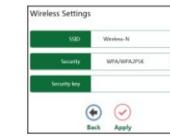
**SSID** – Introduce un valor de hasta 32 caracteres. Este nombre se asignará a todos los dispositivos inalámbricos de tu red. El SSID por defecto es **Wireless-N**.
