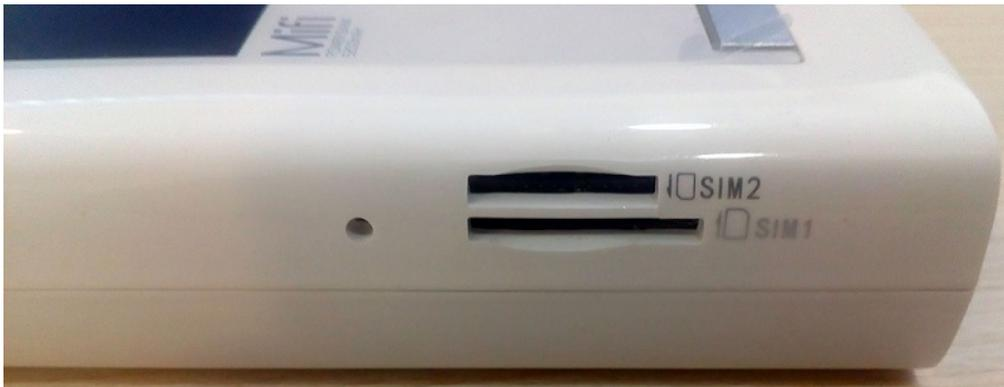
**En el lateral del Router tienes 2 Ranuras para tarjetas SIM en formato normal y micro SIM. Junto a estas conexiones un botón reset para restaurar los valores iniciales.**
