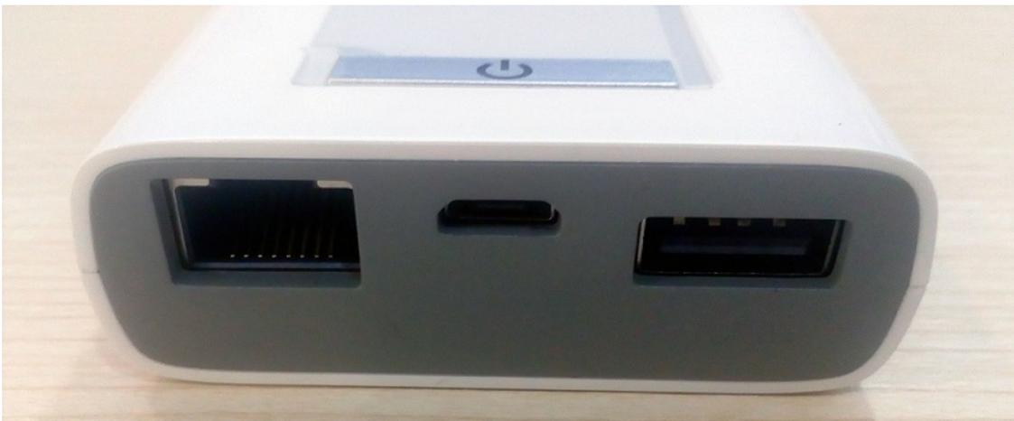
Antes de encender el Router MiFi, comprueba tenga suficiente batería. Para ello en la conexión micro USB debes cargar su batería interna.
