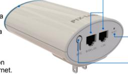
**Puerto WAN/LAN:** Conexión RJ45 para dar conexión cableada a un dispositivo como TV, DVR, consolas, etc. Recuerda que no es posible conectar aquí un router
