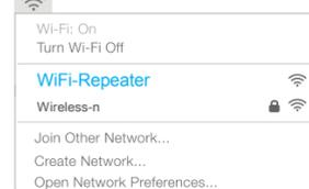
Desconecta la conexión Ethernet (cableada de tu ordenador al Router) y haz clic en el icono WiFi de la parte superior derecha de la pantalla para conectarte a la red WiFi emitida por el repetidor (SSID **WiFi-Repeater**).
