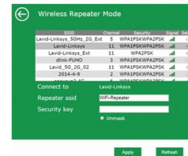
4 Haz clic en el botón "Aplicar" y el repetidor WiFi se reiniciará. Tras volver a iniciar la configuración se habrá completado creando la nueva red WiFi
